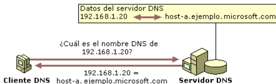
Para que este proceso funcione, hay que utilizar un servidor ficticio denominado in-address-arpa (utilizado para IPv4), hay que asignarlo en un fichero de configuración utilizando el registro PTR.
